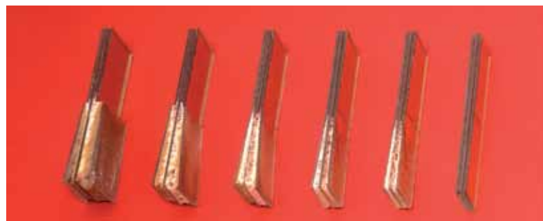
Рис.4.6.2.2. Образцы огнестойкого многослойного стекла AGC Pyrobel после воздействия огня.
